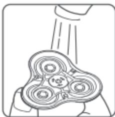
5. Otočte holící hlavu, abyste ji vyčistili pod kohoutkem. Doporučuje se použít teplou vodu a k utření hlavy nepoužívejte ručník ani papírový ručník.
