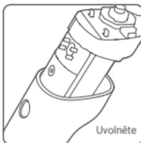
2. Pomocí křížového šroubováku vyjměte šrouby z vnitřní části a poté použijte standardní šroubovák k otevření vnitřní části ze spodní strany. Odřízněte kontaktní destičku z baterie a dejte pozor, abyste destičku nezkratovali. Vyjměte baterii a zacházejte s ní opatrně.
